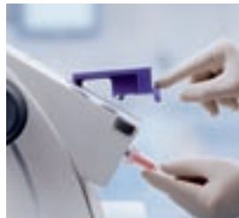
Einfach einzusetzende Mischkanüle ohne Öffnen der Geräteabdeckung
